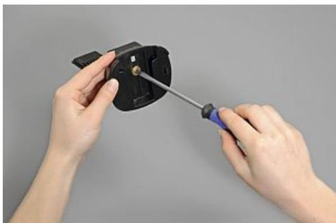
Fixe a barra de fixação ao suporte para câmara usando o parafuso de fixação fornecido. Com uma chave de parafusos, ajuste a barra ao tamanho do seu televisor. Aperte, agora, o parafuso firmemente.
