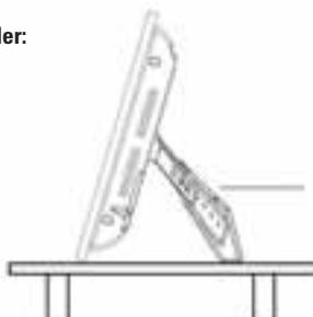
Der Aufstellwinkel des digit. Bilderrahmens kann mit dem verstellbaren Ständer verändert werden. Ziehen Sie den in 6 verschiedenen Längen verstellbaren Ständer heraus, um ihn wie gewünscht anzupassen.
