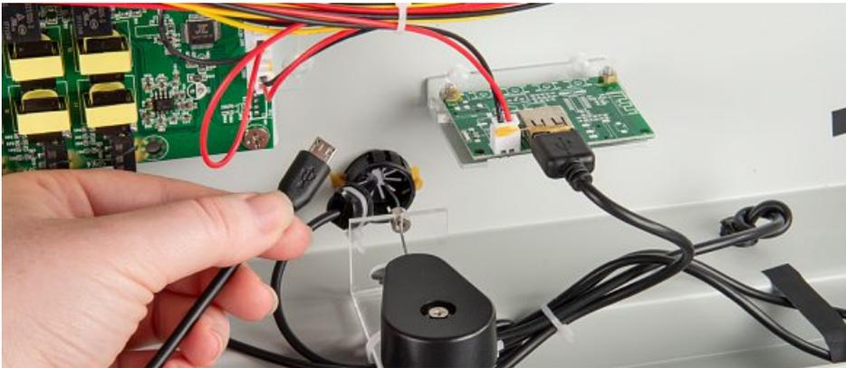
Ziehen Sie dieses nach unten durch die Öse. Das nicht benötigte Kabel kann entweder lose im Board verbleiben (teils mit einem Kabelbinder fixiert) oder entsorgt werden.
