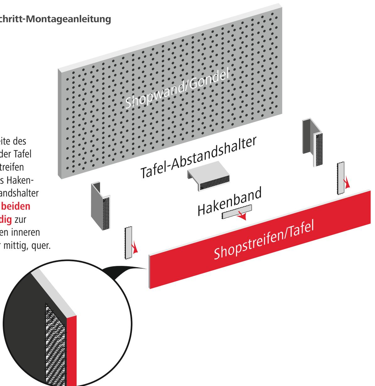
Bei den breiteren Tafeln ist der innere Abstandshalter (mittig, quer, nach unten geöffnet) als zusätzliches Mittelstück zur Stabilisierung vorgesehen, bei den kürzeren Tafeln wird er nicht benötigt.
