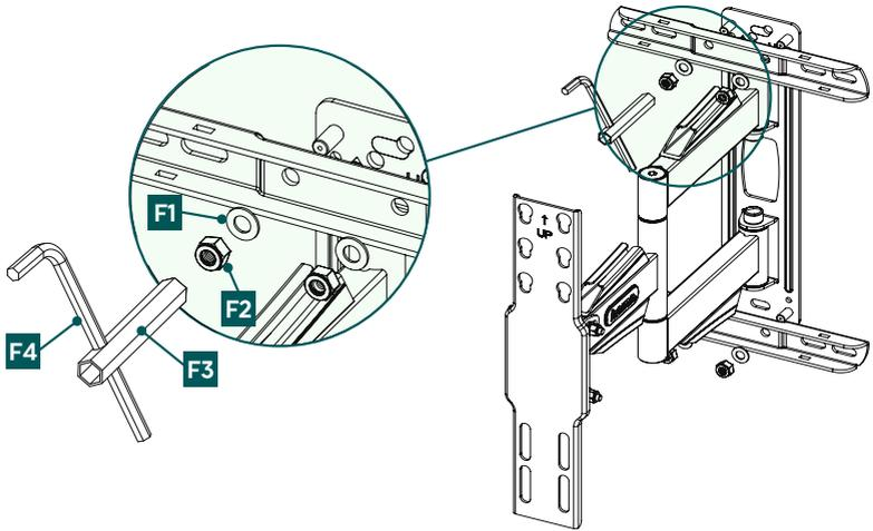
Coloque los travesaños horizontales en la placa de montaje para la pared tal como se muestra arriba. Compruebe que usa la misma combinación que se muestra arriba de tuerca de brida [F2] y arandela [F1]. Para la fijación use la llave de tubo [F3] y llave Allen [F4] incluidas.
