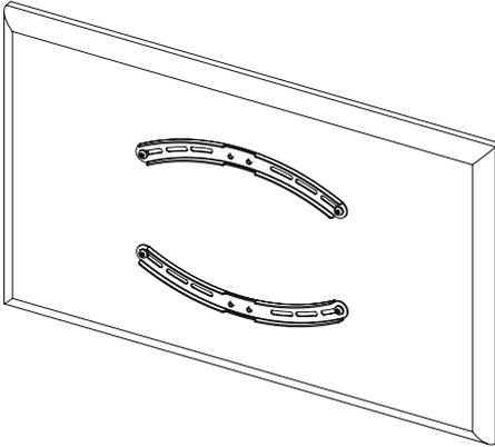
Al posicionar los brazos VESA en la parte trasera del televisor, compruebe que usa los enganches VESA adecuados. Los brazos VESA pueden alinearse de forma distinta según la variante VESA utilizada. Estos se colocan curvados hacia dentro (ver 6.3.1) o hacia fuera (ver 6.3.2).
