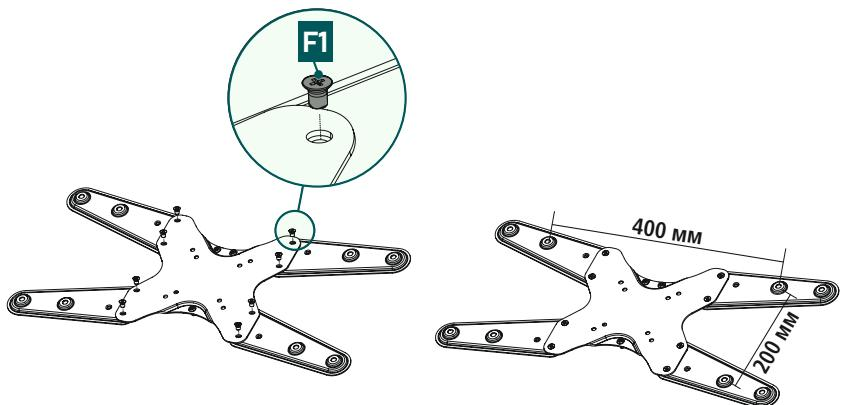
Закрепите прилагаемые адаптерные пластины на обратной стороне пластины VESA с помощью шурупов [F1].
