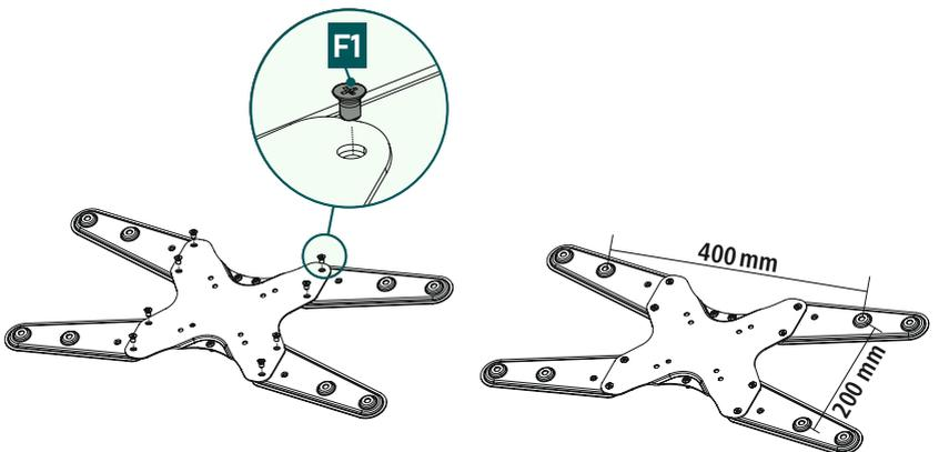
Monte as placas adaptadoras fornecidas na parte de trás da placa VESA utilizando os parafusos [F1].
