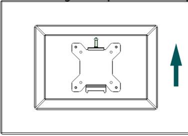
Durante a montagem da placa VESA na parte de trás do televisor, certifique-se de que o parafuso de fixação está em cima.
