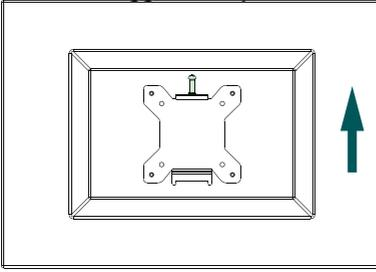
Durante il montaggio della piastra VESA sul retro del televisore, fare attenzione che le vite di fissaggio sia disposta in alto.
