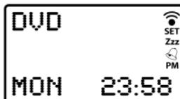
**Wyświetlacz LCD** zawsze wskazuje aktywny tryb pilota (TV, DVD itp.) oraz bieżący czas. Wskazania te są wyświetlane dopóki bateria się nie wyczerpią.
