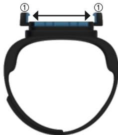
Lege dein Smartphone in die Halterung, bis die Klammern das Handy vollständig und fest umschließen. Die Klammern sollten dabei keine Seitenknöpfe des Handys durchdrücken.
