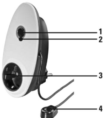
1 Bouton On/Off (marche/arrêt) – pour allumer et éteindre manuellement ou pour commuter dans le mode apprentissage
