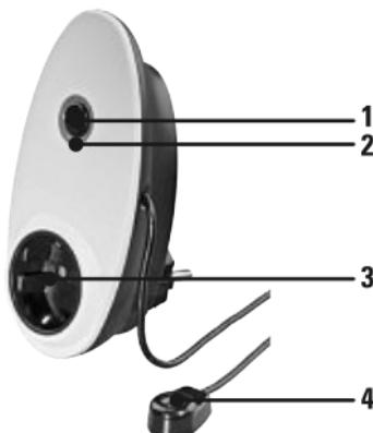
1 Taste On / Off – manuelles ein- und ausschalten bzw. Wechsel in den Lernmodus
