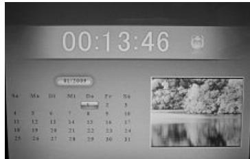
**Ajustes:** El calendario, al igual que la hora, se ajusta del siguiente modo. Seleccione el punto „Setup“ del menú principal y confirme con la tecla „Enter“ para llamar el menú de configuración. En la opción de configuración „Hora“ puede ajustar ahora la hora y la fecha actuales. Seleccione Año, Mes, Día, Horas y Minutos en cada caso y cambie el valor con las teclas „▲▼“. Confirme seguidamente sus entradas con la tecla “Enter”.
