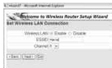
Si vous désirez utiliser le module réseau local sans fil intégré, vérifier que Enable est sélectionné pour l'option "Wireless Lan".
