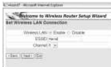
Si vous désirez utiliser le module réseau local sans fil intégré, vérifiez que Enable est sélectionné pour l'option "Wireless Lan".
