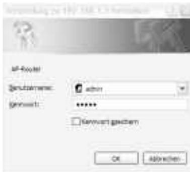
Standard-brugernavn er admin og standard-password er: admin. Klik efter indtastningen på OK for at logge på til routeren. Begynd derefter routerkonfigurationen. (se billedet nedenfor)
