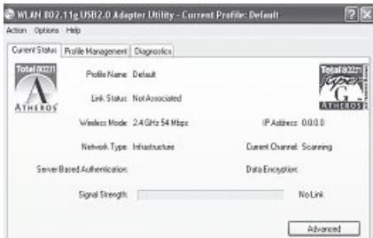
I dette vindue får du informationer om forskellige indstillinger for din Wireless LAN. Hvis objektnetværket, som du skal forbinde med, bliver drevet uden kryptering, er det muligt, at WLAN enheden allerede automatisk har forbundet sig med et netværk, der er til rådighed. I så fald vises modtagelsesstyrken allerede i den underste vindueshalvdel.
