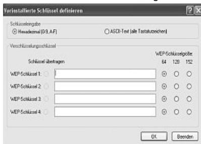
Die Angaben die Sie an dieser Stelle machen, müssen exakt mit den verwendeten Verschlüsselungsdaten im Zielnetzwerk, also am Wireless LAN Router/Accesspoint im Infrastructure Modus und bei allen Client WLAN Geräten im Ad-Hoc Modus, übereinstimmen.
