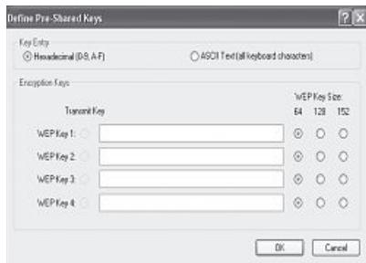
De oplysninger som du giver på dette sted, skal være i fuld overensstemmelse med de benyttede krypteringsdata i objektnetværket, altså med Wireless LAN router/accesspoint i Infrastructure funktion og ved alle Client WLAN enheder i Ad-Hoc funktion.
