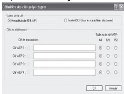
Les informations que vous saisissez dans ce masque doivent correspondre exactement aux données de chiffrement utilisées dans le réseau cible, donc pour le routeur / point d'accès Wireless LAN en mode infrastructure et pour tous les appareils client WiFi en mode ad-hoc.
