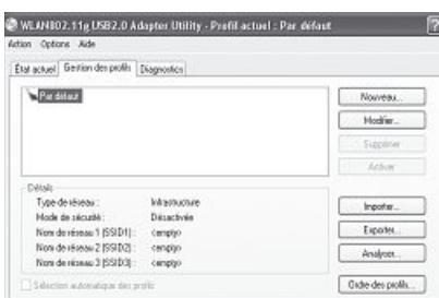
Il est utile de créer un profil afin de configurer votre clé USB. Un profil sert à sauvegarder différentes configurations de connexion sous une certaine dénomination. Il est ainsi possible de sauvegarder les configurations de différents réseaux dans des profils, ce qui vous permettra de commuter facilement entre plusieurs réseaux sans fil.
