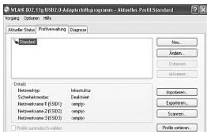
Für die Konfiguration Ihres USB Sticks ist es hilfreich ein Profil anzulegen. Ein Profil dient dazu, verschiedene Einstellungen für eine Verbindung unter einem bestimmten Namen abzuspeichern. Möchten Sie sich z.B. abwechselnd mit verschiedenen drahtlosen Netzwerken verbinden, so können Sie die Einstellungen für die Netzwerke in Profilen speichern, wodurch eine schnellerer Wechsel der Konfiguration möglich ist.
