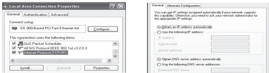
Vælg nu **Obtain an IP address automatically** og **Obtain DNS server address automatically**, hvis der i dit netværk befinder sig en DHCP Server! Bekræft derefter med **OK** og i det følgende vindue ligeledes med **OK!** Din PC er nu konfigureret således, at den automatisk får tildelt IP-adressen fra routeren.
