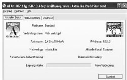
In dieser Ansicht erhalten Sie Informationen über verschiedene Einstellungen ihres Wireless LAN. Sollte das Zielnetzwerk, mit dem Sie sich verbinden möchten ohne Verschlüsselung betrieben werden, ist es möglich, dass sich das WLAN Gerät bereits automatisch mit einem verfügbaren Netzwerk verbunden hat. In diesem Fall wird in der unteren Fensterhälfte bereits eine Empfangsstärke angezeigt.
