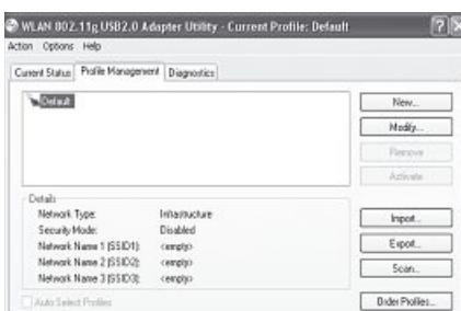
For konfiguration af din USB Stick er det en hjælp at oprette en profil. En profil tjener til at gemme forskellige indstillinger for en forbindelse under et bestemt navn. Har du fx brug for at blive forbundet til skiftende trådløse netværker, så kan du gemme indstillingerne til netværket i profilen, hvorfed et hurtigere skift mellem konfigurationerne er muligt.
