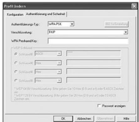
Möchten Sie die **WPA2 Verschlüsselung** nutzen, wählen Sie unter Authentifizierungs-Typ **WPA2-PSK** und unter Verschlüsselung **AES**! Tragen Sie nun noch im Feld WPA Preshared Key den verwendeten Schlüssel ein!
