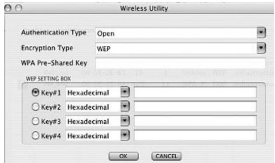
Hier können Sie die erforderlichen Daten für die Verschlüsselung eingeben. Diese müssen identisch mit den Einstellungen am Router oder Accesspoint sein. **Authentication Type** und **Encryption Type** sind im Normalfall, dem Zielnetzwerk entsprechend, bereits ausgewählt. Als nächstes geben Sie bitte den Schlüssel ein, welcher exakt mit dem verwendeten Schlüssel des Routers oder Accesspoints übereinstimmen muss. Haben Sie ihre Werte eingegeben, bestätigen Sie mit **OK**.
