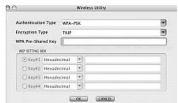
Le code saisi doit être rigoureusement identique au code utilisé dans le réseau. Le code comporte au moins 8 caractères et au plus 63 en cas de codage **ASCII** ; les lettres (A-Z), chiffres et signe de ponctuation sont admissibles peuvent être utilisés. Le codage **HEX** (64 caractères) permet exclusivement l'utilisation des caractères 0-9 et a-f. Vous trouverez ce code dans votre routeur / votre point d'accès ou consultez l'administrateur responsable de la configuration des appareils.
