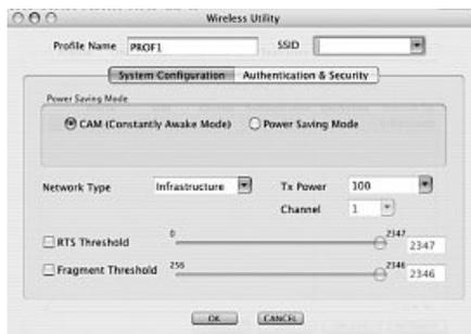
La clé USB WiFi (WLAN) de Hama vous permet d'établir deux types de réseaux différents. Sélectionnez **Infrastructure** sous Type de réseau dans le cas où vous désirez utiliser un routeur ou un point d'accès pour vous connecter. Tous les autres réglages **TX Power**, **RTS Threshold** et **Fragment Threshold** sont faits de telle sorte que vous pouvez tous les conserver.
