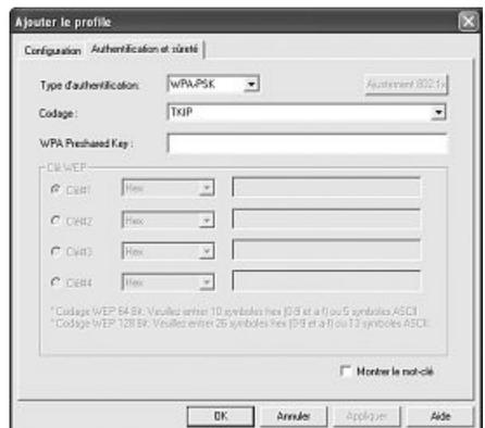
Sélectionnez **WPA2-PSK** sous Type d'authentification et **AES** sous Chiffrement dans le cas où vous désirez utiliser le **chiffrement WPA2**.
