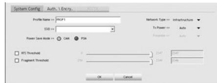
**Ad-hoc:** Seleccione este tipo si quiere conectar directamente a otro dispositivo/cliente wireless LAN. Como por ejemplo otro dispositivo USB, una tarjeta PCI, que no dispongan de un router wireless LAN o punto de acceso. Se requieren dos dispositivos WLAN para ello.
