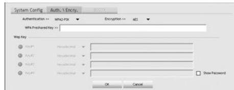
Guarde las configuraciones y haga click en **OK**. Para activar el perfil creado, cambie a la pestaña de **Profiles**, seleccione el perfil y luego haga click en **Activate**.
