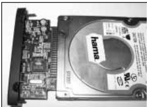
Nachdem Sie die Festplatte und das Gehäuserückteil korrekt miteinander verbunden haben, schieben Sie die Festplatte mit dem Gehäuserückteil wieder in das Aluminiumgehäuse.
