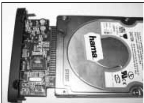
Après avoir connecté le disque dur à la partie arrière du boîtier, insérez le disque dur et la partie arrière du boîtier dans votre boîtier d'ordinateur.
