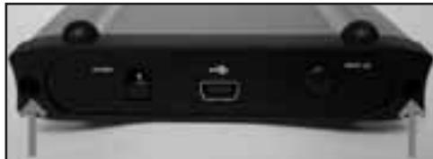
Stecken Sie das Gehäuserückteil mit den dafür vorgesehenen Buchsen auf die Anschlussreihe der Festplatte. Der „Pin1“ ist sowohl auf dem Gehäuserückteil als auch auf der Festplatte markiert.
