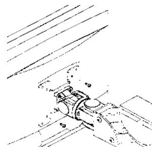
För montering av LCD-monitorn på monitorarmen krävs en andra persons hjälp. Denna person skall hålla fast LCD-monitorn medan du skruvar fast monitorn i fästet med passande skruvar.
