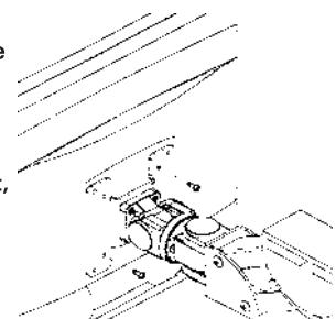
Pro montáž LCD monitoru na rameno jsou zapotřebí 2 osoby. Monitor se musí pøidržovat, mezitím pevně našroubujte šrouby.
