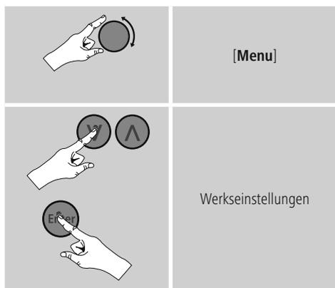
Bestätigen Sie die folgende Abfrage mit **Ja**, um das Radio auf Werkseinstellungen zurückzusetzen.
