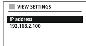
Ανοίξτε τώρα το πρόγραμμα περιήγησης διαδικτύου στο smartphone, το tablet ή τον υπολογιστή σας και εισαγάγετε τη διεύθυνση IP στη γραμμή διεύθυνσεων του προγράμματος περιήγησης. (π.χ. <http://192.168.2.100>)
