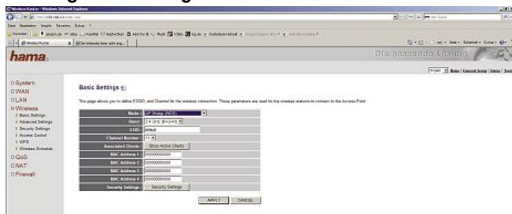
WDS (Wireless Distribution System) is de aanduiding voor de draadloze verbinding tussen meerdere Access Points onderling. Bovendien wordt de login van cliënt mogelijk gemaakt, wat andere Bridge bedrijfsmodi niet toelaten. Hierbij wordt voor ieder extra Access Point de bandbreedte van het net gehalveerd, omdat de pakketten dubbelovergebracht moeten worden.
