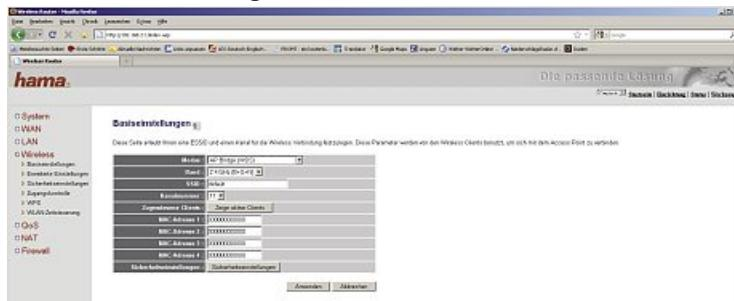
WDS (Wireless Distribution System) bezeichnet die drahtlose Verbindung zwischen mehreren Access Points untereinander. Außerdem wird die Anmeldung von Clients ermöglicht, was andere Bridge Betriebsarten nicht zulassen. Dabei wird für jeden zusätzlichen Access Point die Bandbreite des Netzes halbiert, weil die Pakete doppelt übertragen werden müssen.
