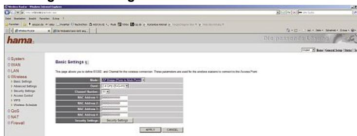
Het verschil met de AP Bridge-Point to Point werking is dat u in deze modus MAC-adressen van meerdere Access Points kunt invoeren. Een Bridge-verbinding is maximaal met 4 andere Access Points mogelijk.
