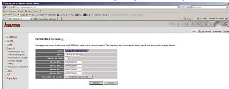
Ce mode de fonctionnement diffère du mode de fonctionnement AP pont point à point dans le sens qu'il vous permet de saisir les adresses MAC de plusieurs points d'accès. Une connexion pont est possible vers un maximum de 4 autres points d'accès.
