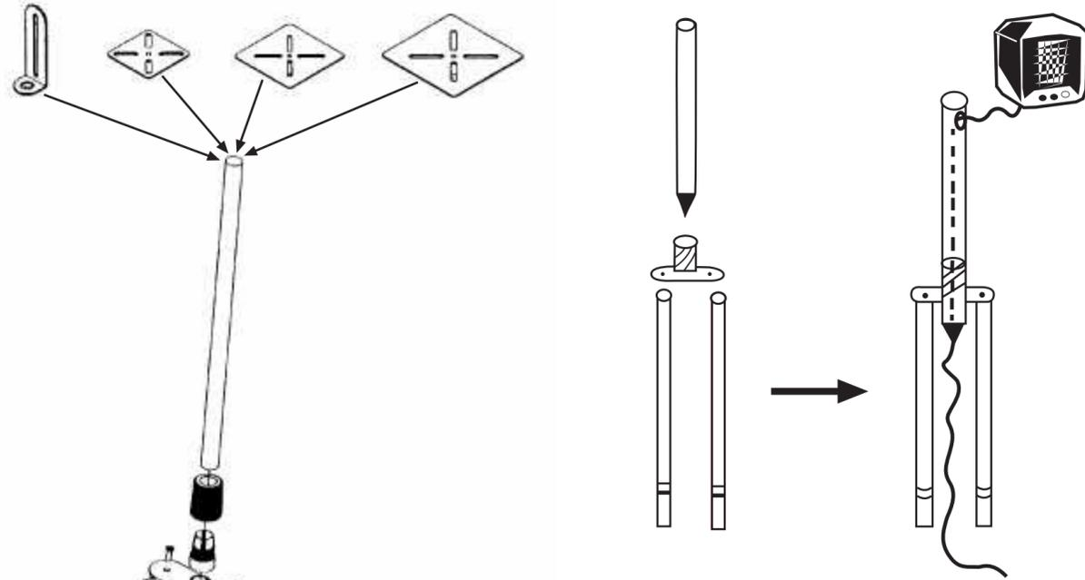
**!** Die beiden Tragerohre müssen parallel in einem leichten Winkel nach hinten geneigt sein! Die Tragerohre sind dann korrekt ausgerichtet, wenn das mittlere Lautsprecherrohr ebenfalls parallel zu den beiden Tragerohren verläuft!
