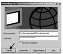
Sobald Sie auf "Wählen" geklickt haben, wird die DSL-Verbindung aufgebaut. Der Verbindungsaufbau sollte nach wenigen Sekunden abgeschlossen sein. Bleibt das Fenster längere Zeit unverändert, haben Sie möglicherweise Benutzername oder Passwort falsch eingegeben. Warten Sie bis der Verbindungsaufbau abbricht, korrigieren Sie Ihre Zugangsdaten und versuchen Sie erneut einen Verbindungsaufbau.
