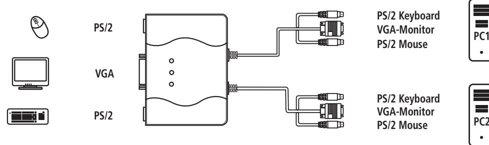
**Anschließen der Peripheriegeräte und der PC's**
