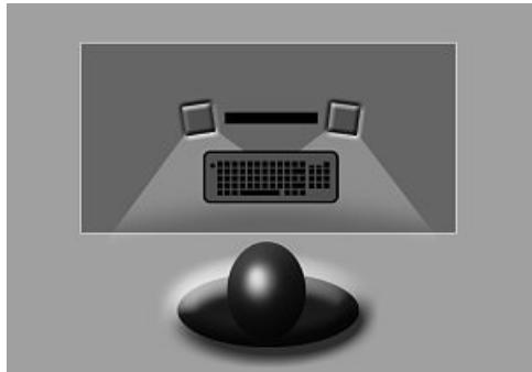
1. Stel de luidsprekers rechts en links van de monitor op en zorg ervoor dat ze in uw richting wijzen.
