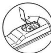
Pressez le bouton de déverrouillage complètement en cas d'un long temps d'exposition ou si vous prenez successivement beaucoup de photos et poussez-le vers la direction de la flèche. Le bouton s'encliquette dans le bouton étant situé plus bas. Repousser maintenant le bouton vers sa position originale.
