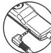
Mettez le cordon de synchronisation dans la prise de synchronisation du câble de télécommande pour que deux appareils photographiques prennent en même temps des photos. (seulement pour des modèles spécifiques)
