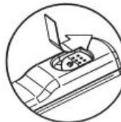
Drücken Sie bei langen Belichtungszeiten oder andauerndem Fotografieren den Entriegelungsknopf ganz und schieben Sie ihn in Pfeilrichtung. Die Auslösetaste rastet dadurch in den tieferliegenden Schacht ein. Nach Beendigung der Belichtungszeit schieben Sie nun den Knopf in seine ursprüngliche Position zurück.
