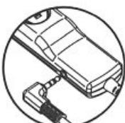
Inserte el cable de sincronización en la hembrilla de sincronización del cable del mando a distancia para poder fotografiar simultáneamente con dos cámaras.
