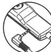
Um mit zwei Kameras gleichzeitig zu fotografieren benötigen Sie ein Synchronkabel, stecken Sie dieses in die Synchronbuchse des Fernbedienungskabels.
